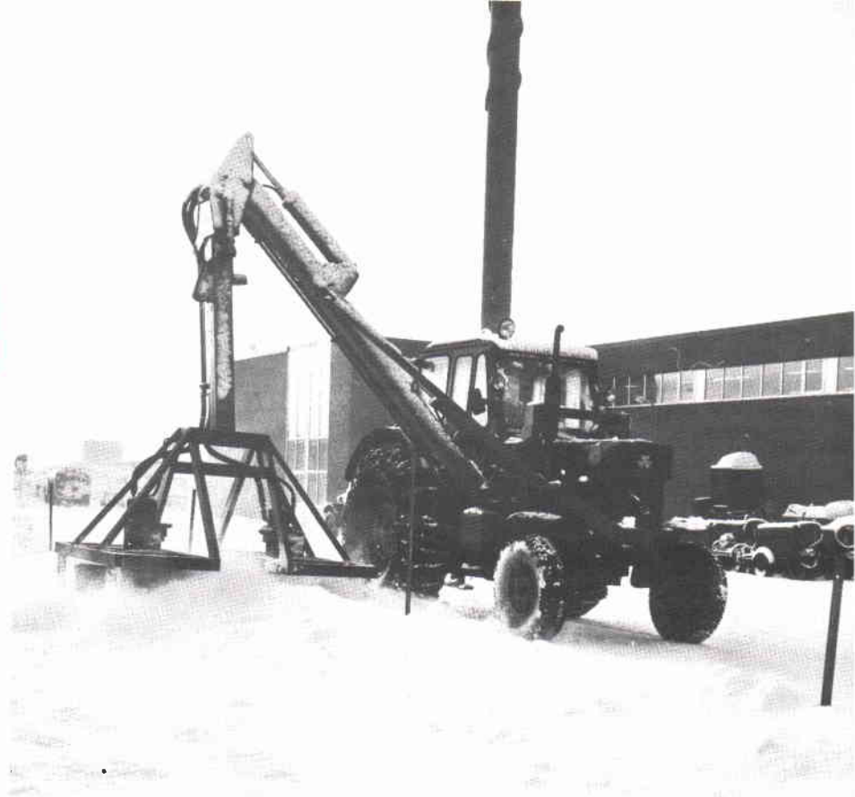
Ett nytt provaggregat sopar bort snön runt banljusen, vilka här markerats med käppar. Man kan även utveckla aggregatet så att det kan klippa gräset runt banljusen.
